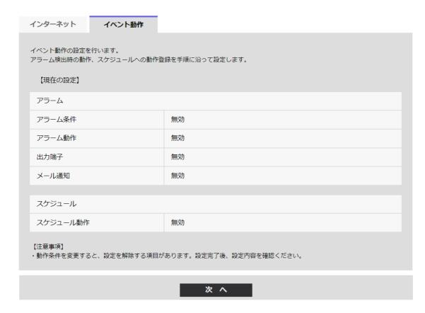
[イベント動作]では、SDスケジュール録画/<u>SFTP定期送信</u>/アラーム検知時のイベント動作を設定できます。各設定画面で設定が完了したら、[次へ] ボタンをクリックして進んでください。
