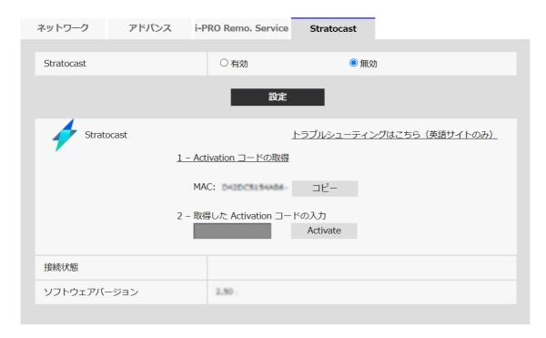
Stratocastは、Genetecが提供するクラウドベースのビデオ監視サービスです。ネットワー クカメラをクラウドサーバーに登録し、カメラ映像を確認できます。
