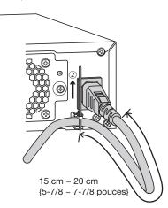
② Serrez le cordon d'alimentation à 15 cm à 20 cm {5-7/8 à 7-7/8 pouces} du connecteur et fixez-le au support de serrage.
