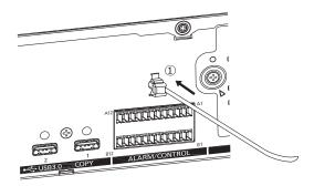
① Insérez le serre-câble (accessoire) dans le trou de fixation du serre-câble.
