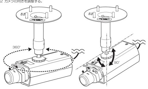
3 六角レンチで六角穴を回し、可動部の固定を締める。 対辺3mm 六角レンチ(現地調達)
