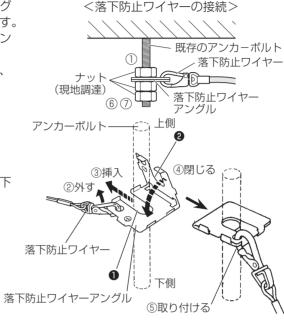
● 既存のアンカーボルトを使用して 落下防止ワイヤーを接続する場合、 中間挿入式ナットを2個使用すると 便利です。
