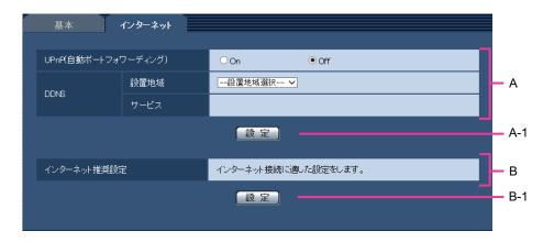
A欄の項目の設定が終了したら、A欄の下の[設定]ボタン(A-1)をクリックします。 A欄の下の[設定] ボタン(A-1)をクリックしないと、設定内容が確定されません。 上記と同様にB欄の項目の設定が終了したら、B欄の下の[設定]ボタン(B-1)をクリックします。
