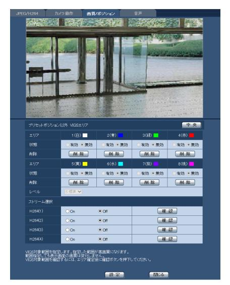
プリセットポジション以外のVIQSエリアを設定する場合は、「プリセットポジション以外」を選択します。
