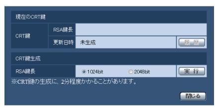
**2** [CRT鍵生成-RSA鍵長] で、生成するCRT鍵の長さを1024bit/2048bitから選択します。
