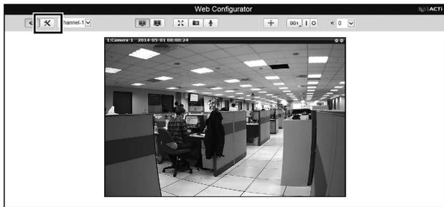
4. [IP 設定]、[接続の種類] の順にクリックし、[静的 IP アドレス] をクリックしてから、エンコーダーに付与する IP アドレスとサブネットマスク、ゲートウェイを入力して [適用] をクリックします。
