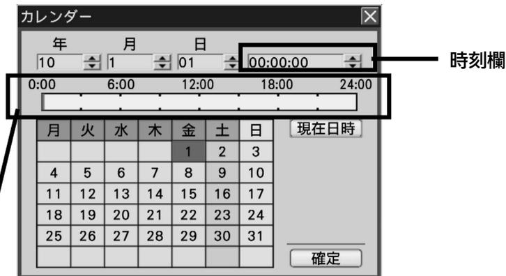
時刻バー：時刻バー上をマウスでクリックすると、15分単位でクリックした位置の時刻を時刻欄に入力することができます。
