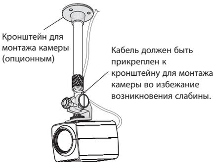
**<Пример монтажа на стену>**
