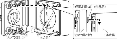
4 対辺3 mmの六角レンチ(現地調達)を使って、六角穴付きねじ(4本)(M4:付属品)で 固定します。
