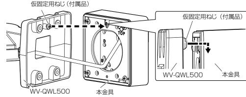
**2** WV-QWL500 を対辺3 mmの六角レンチ(現地調達)を使って、六角穴付きねじ(4本) (M4:付属品)で本金具に固定します。
