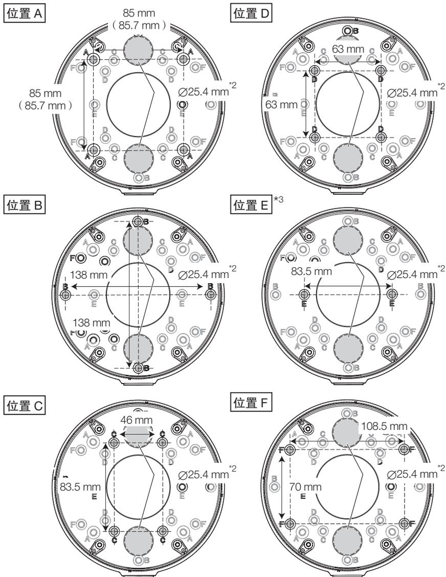
\*2 安装底座支架时, 选择模板纸 B (附件) 的两个布线孔中的任意一个。固定好安装板后, 可 90° 旋转摄像机。
