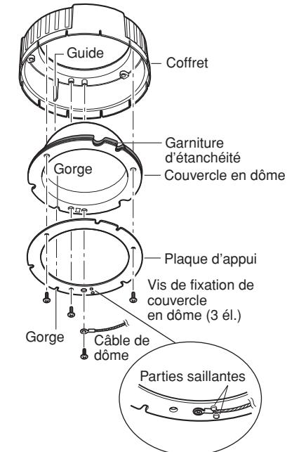
4. Assembler le bloc principal et le boîtier en utilisant les trois vis de fixation du boîtier. Serrer les vis de fixation du coffret au couple de serrage prescrit:
