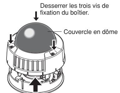
2. Séparer le couvercle en dôme du boîtier en retirant les trois vis de fixation du couvercle en dôme.
