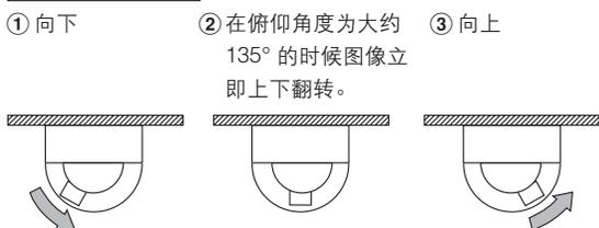
需要进行图像数字翻转操作时，向下扳动系统控制器的操作杆即可。
