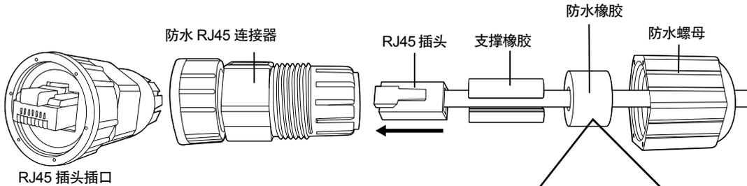
根据以太网电缆外径附带两种类型的防水橡胶。
