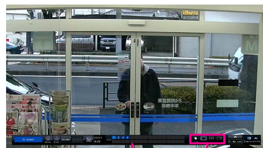
Panneau de numéro de caméra vidéo Boutons de sélection d'écran à découpage multiple
