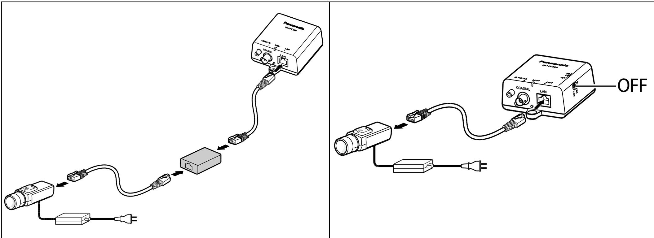
4.2 Collegamenti (1. Collegare un cavo Ethernet (Cat-5e o superiore) all'unità lato telecamera e alla telecamera di rete.)
