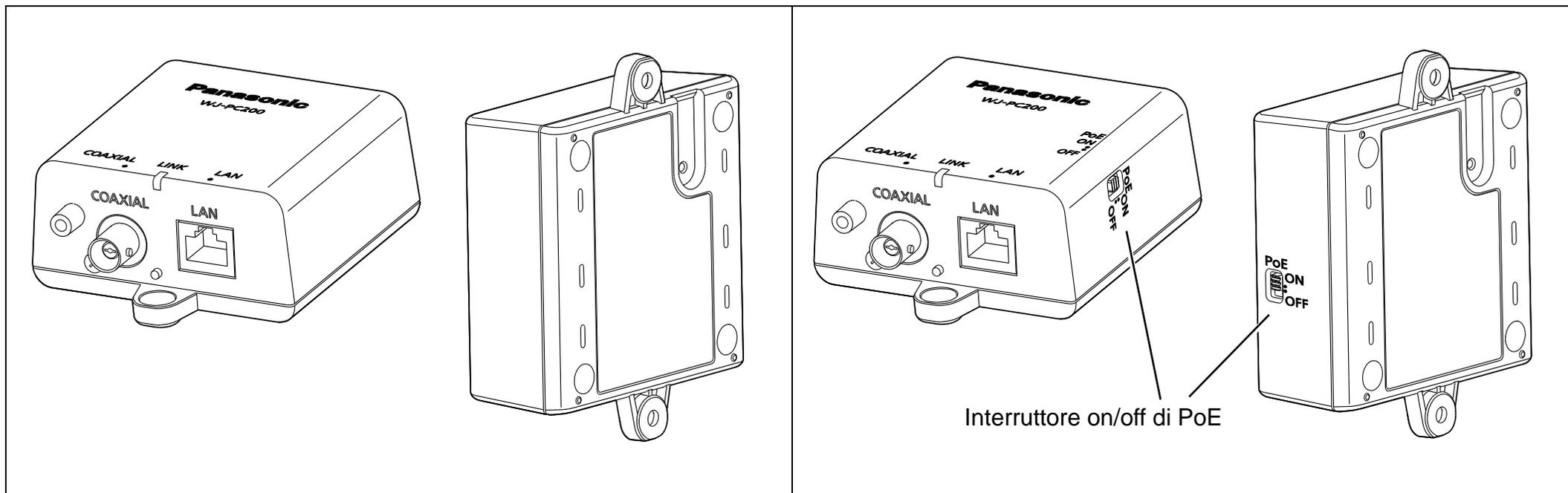
4.1.1 Quando si utilizza un'unità lato ricevitore a 1 canale (Quando si collega una telecamera PoE o PoE+ ad un alimentatore esterno.)
