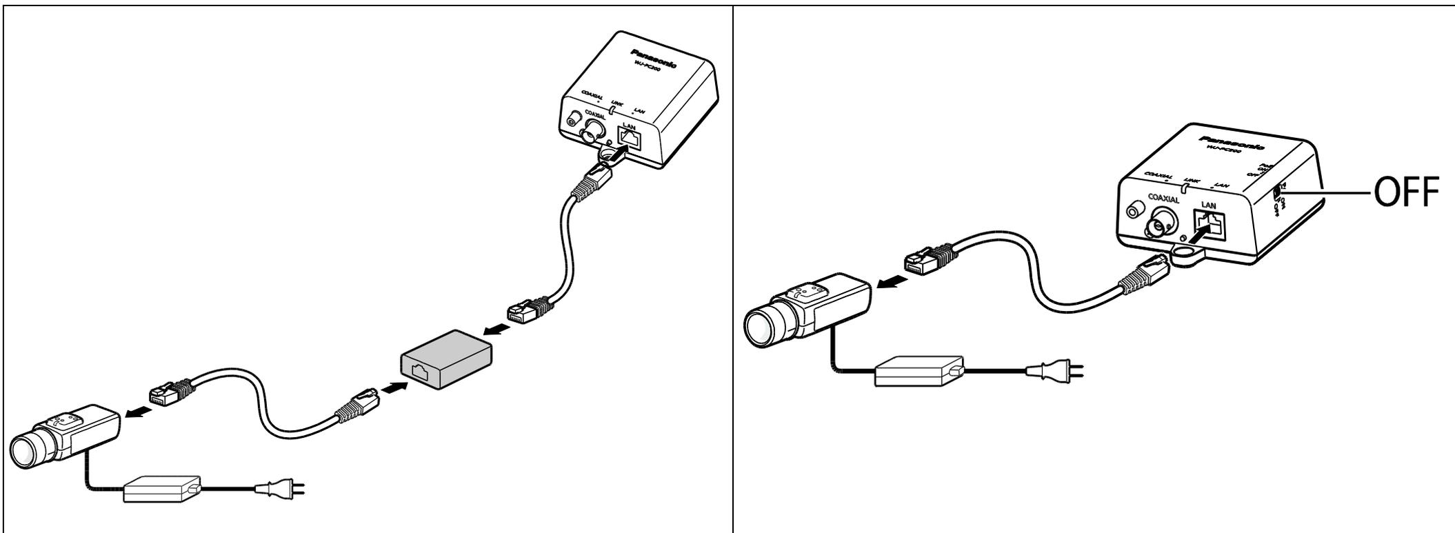
**4.2 Conexiones (1. Conecte un cable de Ethernet (Cat-5e o superior) a la unidad del lado de la cámara y a la cámara de red.)**
