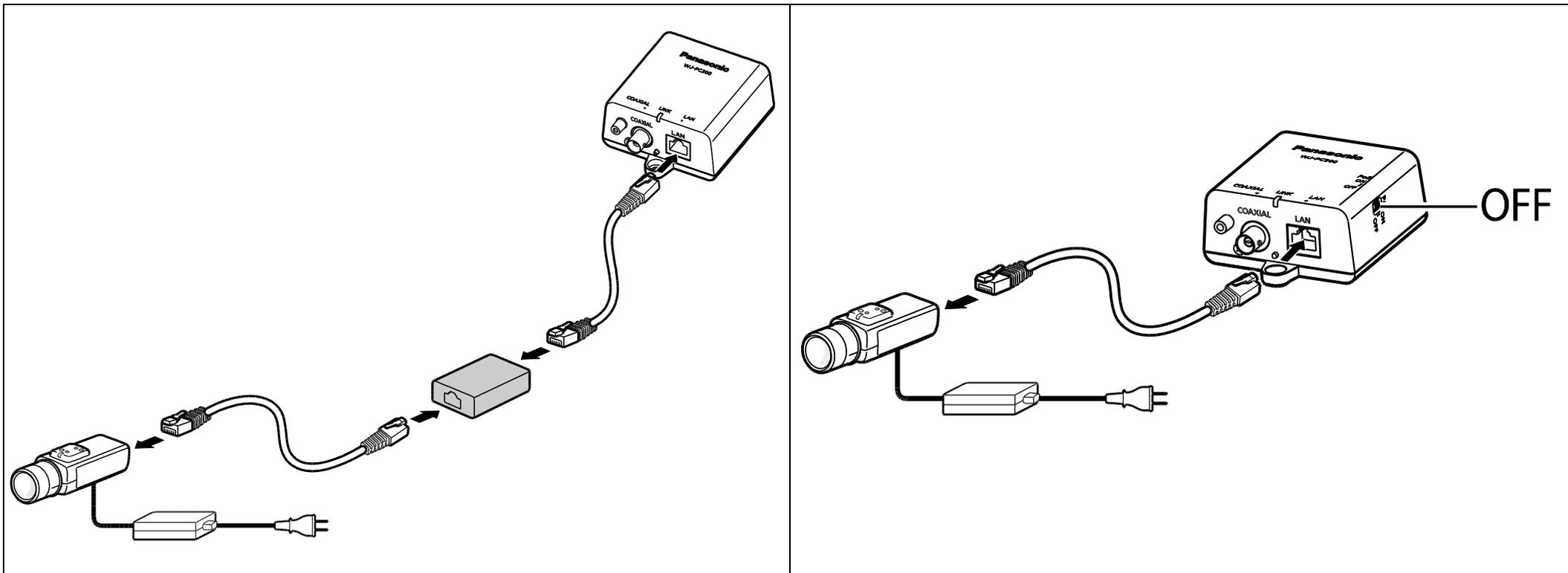
**4.2 Connexions (1. Connecter un câble Ethernet (Cat-5e ou de type plus élevé) à l'appareil côté caméra vidéo et à la caméra vidéo de réseau.)**
