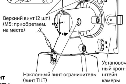
② Ослабьте горизонтальный винт-ограничитель (винт PAN) примерно на 1 оборот, временно затяните винты после поворота камеры вверх, а затем зафиксируйте нижние винты камеры (2 шт.) (M5: приобретаем. на месте).
