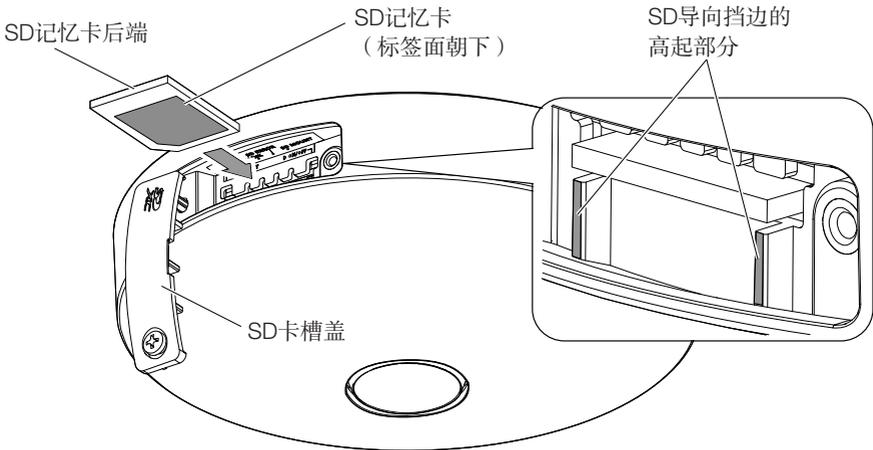
**【2】** 关闭摄像机侧面的SD卡槽盖。
