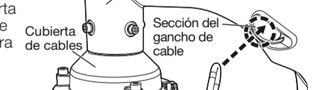
Cubierta de cables, Sección del gancho de cable, Cámara, Cable de seguridad, Gancho del cable en la parte superior de la cámara
