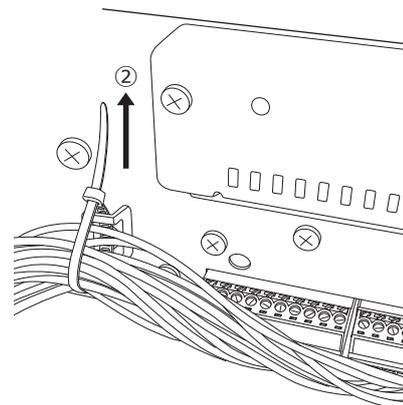
② Ate los cables de los terminales ALARM/CONTROL y fíjelos con la abrazadera del cable.
