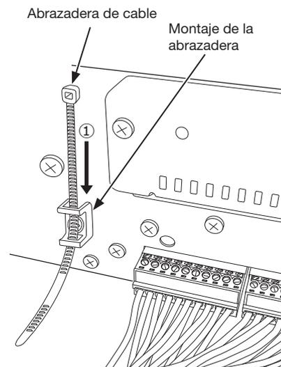
① Pase la abrazadera de cable (suministrada) a través de la abrazadera de montaje.
