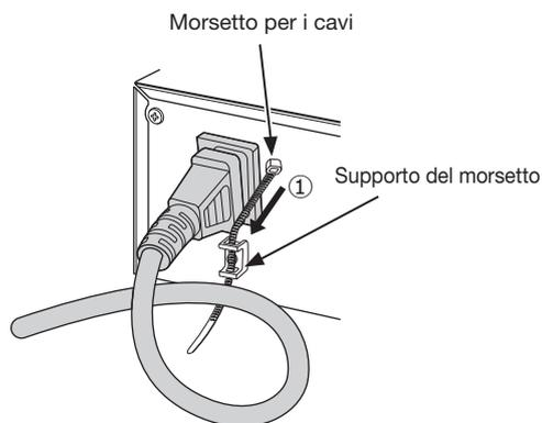
① Far passare il morsetto del cavo di alimentazione (fornito) attraverso l'apposito supporto.
