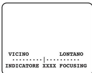
**4 Per eseguire una regolazione precisa del fuoco posteriore dopo lo spegnimento dell'indicatore di funzionamento dell'ABF e la regolazione automatica del fuoco posteriore, utilizzare i tasti Destra o Sinistra.**
