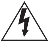
El símbolo del relámpago con cabeza de flecha, dentro de un triángulo equilátero, tiene la función de llamar la atención del usuario a la presencia de "tensión peligrosa" no aislada dentro de la caja del producto que puede ser de intensidad suficiente para constituir un riesgo de sacudidas eléctricas a las personas.
