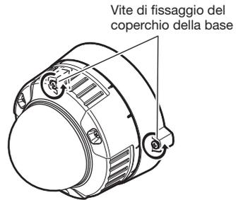
Vite di fissaggio del coperchio della base
