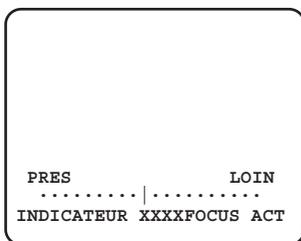
**4 Pour faire un réglage précis du foyer arrière après que l'indicateur de position ABF se soit éteint et après avoir fait le réglage de foyer arrière automatique, utiliser le bouton gauche ou le bouton droit.**
