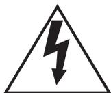
L'éclair à extrémité fléchée placé dans un triangle équilatéral est destiné à attirer l'attention de l'utilisateur sur la présence d'une "tension potentiellement dangereuse" et non isolée se trouvant dans les limites du coffret de l'appareil dont la puissance est suffisante pour constituer un risque important d'électrocution.
