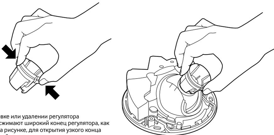
При установке или удалении регулятора объективасжимают широкий конец регулятора, как показано на рисунке, для открытия узкого конца регулятора объектива.
