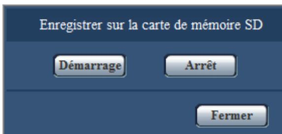
3. Cliquer le bouton [Démarrage] pour commencer l'enregistrement des images sur la carte mémoire SD. L'indicateur de statut d'enregistrement SD s'allume en rouge (→page 22) pendant l'enregistrement des images sur la carte mémoire SD. L'intervalle de sauvegarde d'image peut être configuré à l'onglet [Carte de mémoire SD] de la page "Base". (→page 79)
