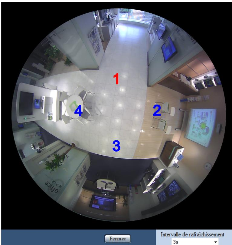
À partir de cette fenêtre, la position de l'image de chaque numéro d'écran peut être changée. Par un tirer-déposer de l'icône de numéro de l'écran sur l'image, vous pouvez changer le centre de l'image où l'icône a été déposée.
