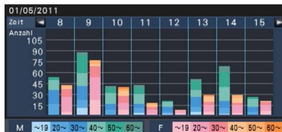
**Horizontalachse:** Wenn für "Anzeigeeinheit" der Posten "Eine Stunde" gewählt wurde, wird das statistische Diagramm stundenweise angezeigt (bis zu 24 Stunden), wurde der Posten "Ein Tag" gewählt, wird das statistische Diagramm wochenweise, unterteilt in die einzelnen Wochentage angezeigt.
