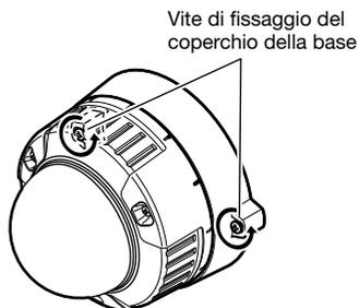
Vite di fissaggio del coperchio della base
