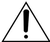
El símbolo del punto de exclamación dentro de un triángulo equilátero tiene la función de llamar la atención del usuario a la presencia de importantes instrucciones de mantenimiento (servicio) en la literatura que acompaña el equipo.
