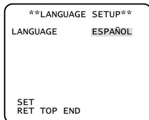
Para cambiar el idioma de utilización, emplee el botón de derecha o de izquierda para seleccionar el idioma deseado, mueva el cursor a "SET", y presione el botón de ajuste.
