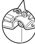
Tornillo de fijación de la cámara (rojo)
