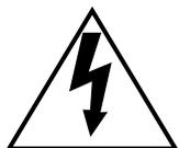
El símbolo del relámpago con cabeza de flecha, dentro de un triángulo equilátero, tiene la función de llamar la atención del usuario a la presencia de "tensión peligrosa" no aislada dentro de la caja del producto que puede ser de intensidad suficiente para constituir un riesgo de sacudidas eléctricas a las personas.
