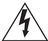
在正三角形中带箭头的闪电符号，用以提醒用户在本装置附近出现较大的非绝缘“危险电压”足以使人体产生触电。
