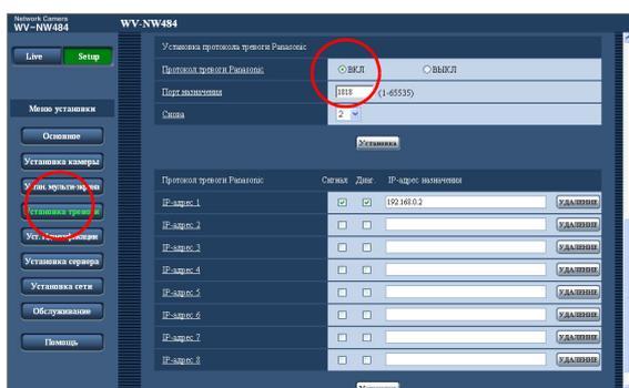
Извещение о появлении тревоги может быть разослано по заранее установленным IP-адресам. Эта функция доступна только в случае, если к системе подключены устройства Panasonic, например, сетевой диск-рекордер. Если для параметра "Протокол тревоги Panasonic" установлено значение "ВКЛ", подключенное устройство Panasonic будет извещено о том, что камера находится в состоянии срабатывания тревожной сигнализации.
