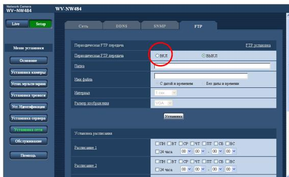
Изображения могут передаваться через определенный интервал или период времени. Для передачи изображений через определенный интервал или период времени необходимо произвести более сложные установки.
