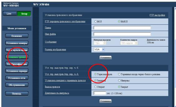
При появлении тревоги возможен вывод сигналов с выходного терминала тревоги и звучание сирены. Установки для выходного сигнала тревоги можно редактировать на закладке [Тревога] на странице "Установка тревоги".
