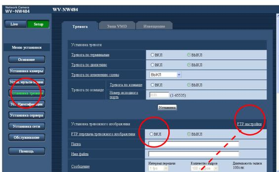
При возникновении тревоги изображение может быть автоматически передано на заранее установленный FTP-сервер.
