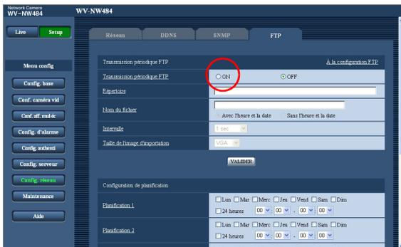
Des images peuvent être transmises à un intervalle ou une période déterminé. Pour transmettre des images à un intervalle ou une période déterminé, il est nécessaire de configurer les paramètres à l'avance.
