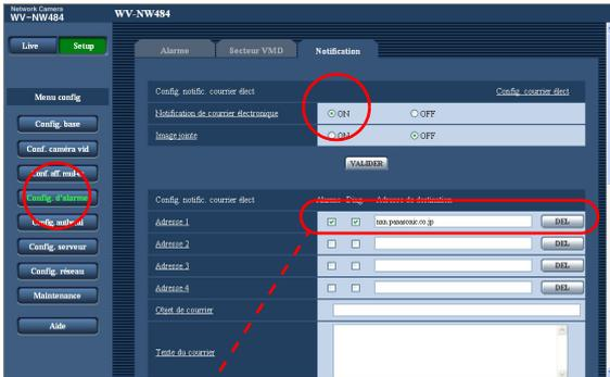
En cas d'alarme, un courrier électronique d'alarme (notification d'une occurrence d'alarme) peut être envoyé à des adresses de courrier électronique préenregistrées. On peut enregistrer jusqu'à 4 adresses pour recevoir le courrier électronique d'alarme. Une image d'alarme (image fixe) peut être envoyée en pièce jointe avec le courrier électronique d'alarme.
