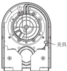
**8** 将上型箱安装至墙上，布排连接线。
