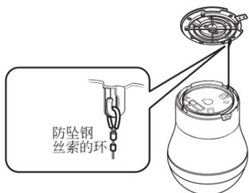
**11** 将摄像机安装至摄像机安装底座，按顺时针方向转动摄像机，紧固安装螺丝（M3，配件）。
