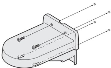
**9** 将拆下的装饰盖(2)放回到支架和摄像机上。
