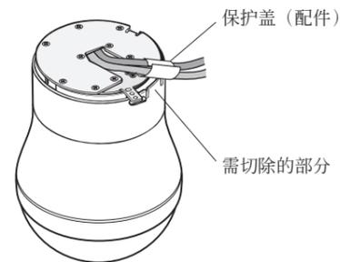
3 拆下安装螺丝（M3，配件），拉起摄像机安装底座，将其从摄像机上拆下，并按逆时针方向转动摄像机。
