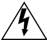
Das Blitzzeichen mit Pfeil im gleichseitigen Dreieck soll den Benutzer auf das Vorhandensein von nichtisolierter "gefährlicher Spannung" innerhalb des Gehäuses hinweisen, die so groß sein kann, daß sie Gefahr eines elektrischen Schlags darstellt.
