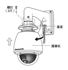
(4) 将彩色摄像机WV-CW960/CH 或WV-CW964CH 附件中的防水盖(3个)套在螺钉上面。
