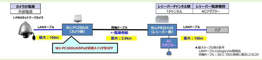
○ 【パターンA'】レシーバー側:外部電源、 カメラ:PoE給電、 同軸ケーブル両端に避雷器を入れた場合
