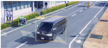
カメラ内で人や車両(2輪車/4輪車)を識別しているイメージ
