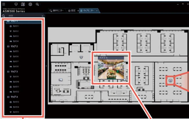
マップ上にカメラのアイコンをマッピングすることで機器配置状態や機器の状態を一元管理することができ、視認性の高いモニタリングが可能です。また、設置カメラの機器状態もマップ上で確認することができます。
