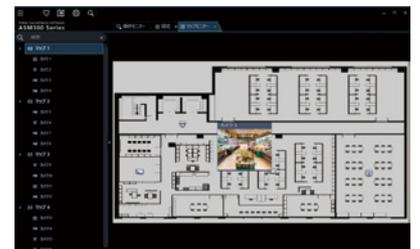
**表示例** ディスプレイが3台の場合は、マルチモニターを使用し、各ディスプレイに操作モニター、ライブモニター、マップモニターを表示する運用が可能です。
