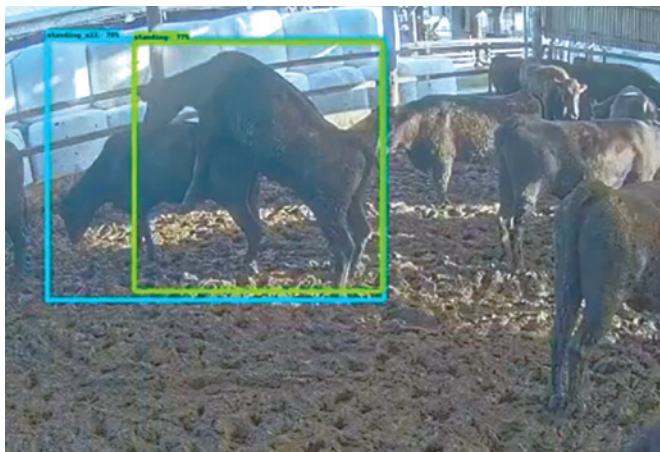
MOOVIE発情検知により牛の発情（乗駕行動）を検知している様子
