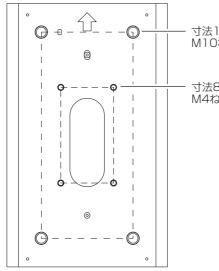
寸法180 mm (高さ) ×80 mm (幅) M10ねじ穴 (4か所)
