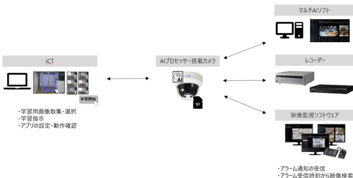
本製品は、AIネットワークカメラ(別売り、以下カメラ)をより便利にお使いいただくためのソフトウェアです。本製品をカメラにインストールし、解除キーを登録することで、正常状態をカメラに学習させ、状態変化時にアラーム通知する機能を利用することができます。
