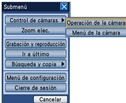
→ Se visualizará el "Menú de la cámara" y el menú de configuración de la cámara se visualizará en el monitor.
