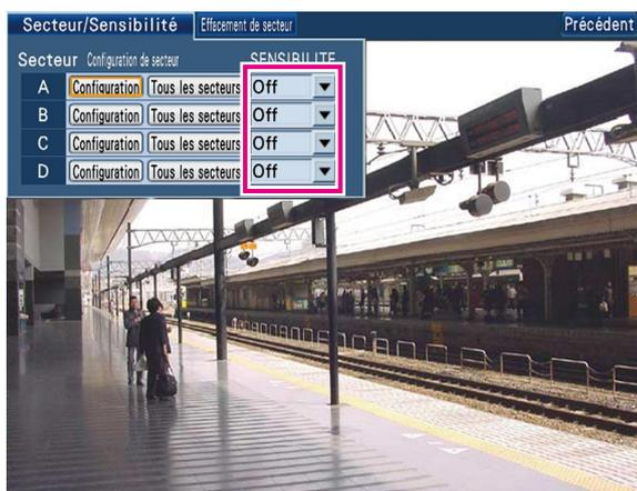
Déplacer le curseur jusqu'au menu déroulant de "Sensibilité" du secteur de détection à paramétrer (A à D) à l'aide du bouton fléché (▼ ▲ ◀ ▶). Ensuite, manœuvrer le volant de commande de marche par impulsions (à l'intérieur) pour sélectionner la sensibilité de détection parmi les options suivantes.
