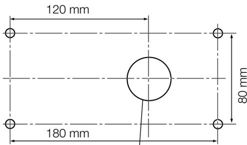
用于电缆安装的孔： $\varnothing 38$  mm
