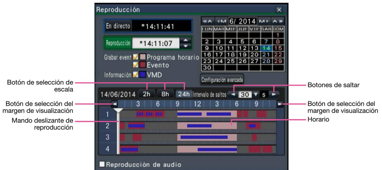
La visualización de reproducción muestra las imágenes grabadas disponibles y las visualiza en un horario clasificado por tipos. Es posible cambiar el tipo de las imágenes grabadas que se visualizan en el horario, cambiar la escala del horario y designar la imagen grabada que se desee reproducir.
