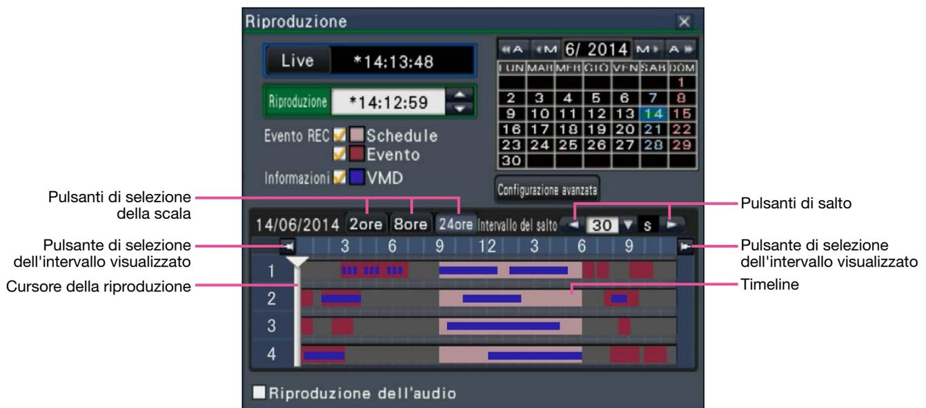
La visualizzazione della riproduzione mostra le immagini registrate disponibili e le visualizza su una timeline suddivise per tipo. È possibile cambiare il tipo di immagini registrate visualizzato sulla timeline, cambiare la scala della timeline e designare le immagini registrate da riprodurre.
