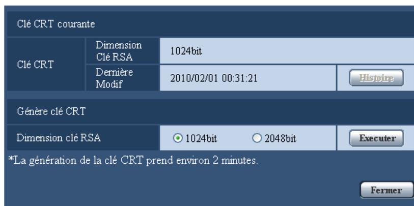
2. Sélectionner “1024bit” ou “2048bit” comme longueur de clé CRT pour la générer pour “Génère clé CRT” - “Dimension clé RSA”.
