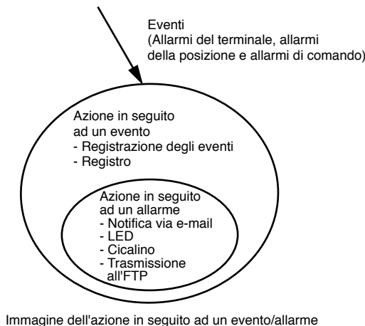
Immagine dell'azione in seguito ad un evento/allarme
