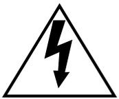
在正三角形中带箭头的闪电符号，用以提醒用户在本装置附近出现较大的非绝缘“危险电压”足以使人体产生触电。
